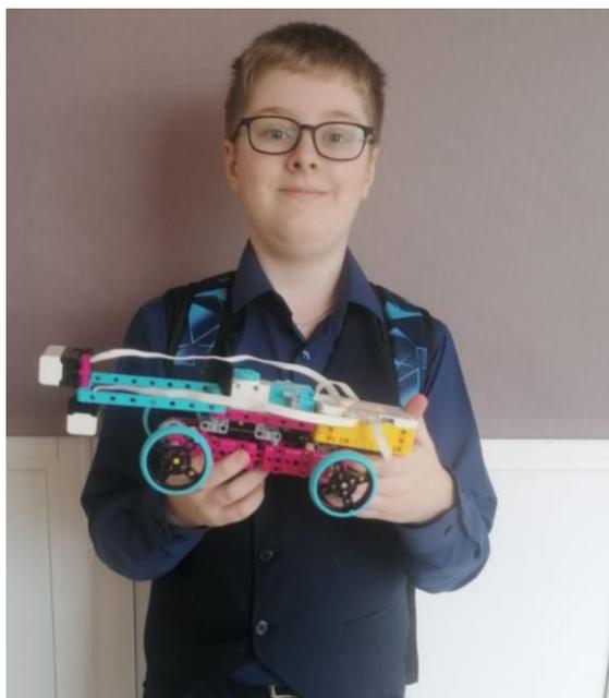
Ученик 6 класса Зенгер Арсений собрал автомобиль с двумя датчиками движения. Датчики реагируют на препятствия, которые встречаются на пути автомобиля. Машина останавливается, если существует опасность, например, обрыв.
